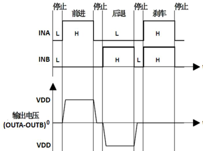
工作电压 2.2-7.5V 持续电流 1.4A 单通道直流马达驱动 IC
